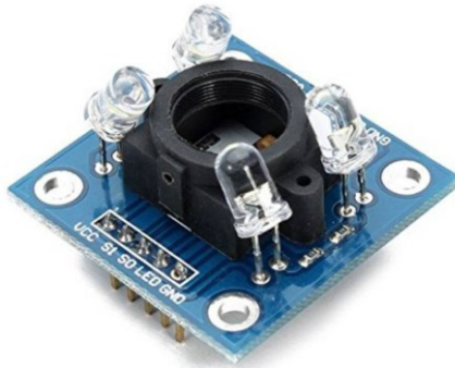
圖 3 顏色感測器圖資料來源：台灣物聯科技。GY-31 TCS3200 顏色感測器 顏色識別模組顏色感應傳感器。
