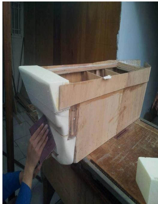
圖 7.8 船艙完成作最後的修飾
